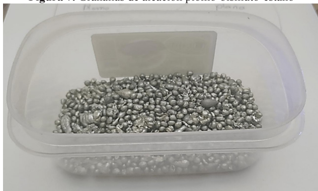
Figura 7. Granallas de aleación plomo-bismuto-estaño
