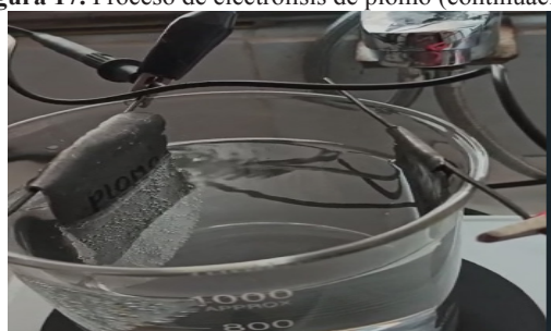
Figura 17. Proceso de electrólisis de plomo (continuación)
