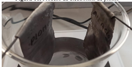
Figura 16. Proceso de electrólisis de plomo
