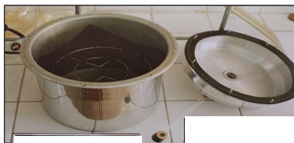
Fig. 3. Sistema-equipos de extracción por Arrastre de Vapor del aceite esencial de Satureja boliviana .
