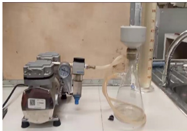
Figura 4. Pretratamiento filtración por membrana
