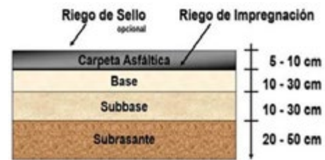
Figura 1. Sección típica de un pavimento flexible datos
