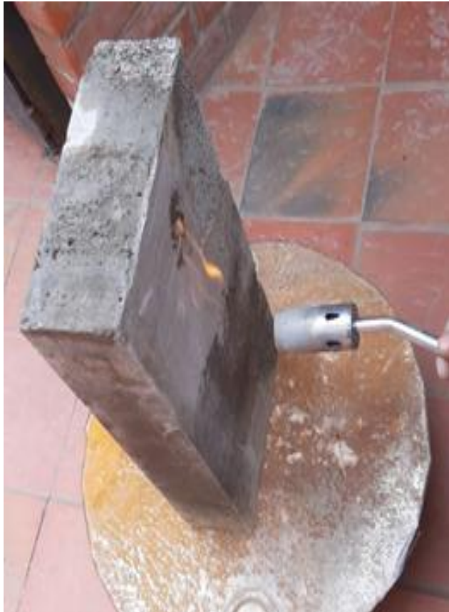
Figura 11. Ensayo de protección contra fuego en bloque de hormigón celular.
