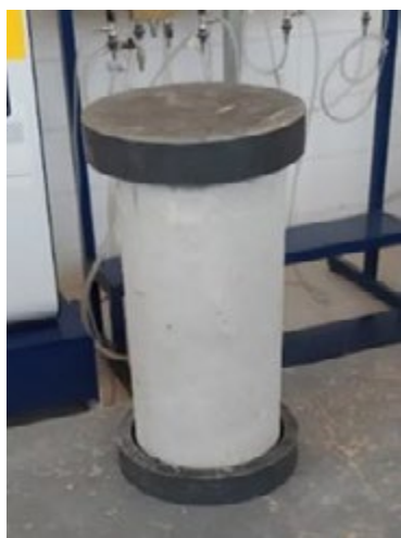
Figura 5. Ensayo a compresión de especímenes de hormigón celular.
