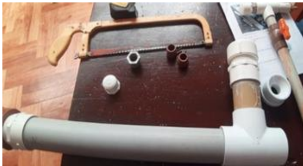
Figura 1. Construcción del generador de espuma.
